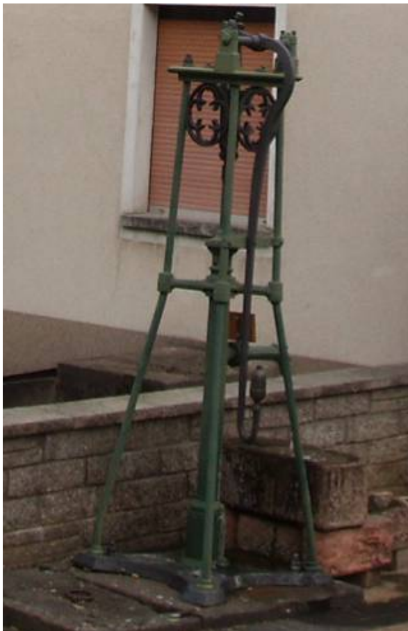
Schwengelpumpe, Gusseisen, Rheinböllener Hütte, 2. Hälfte des 19. Jahrhunderts
