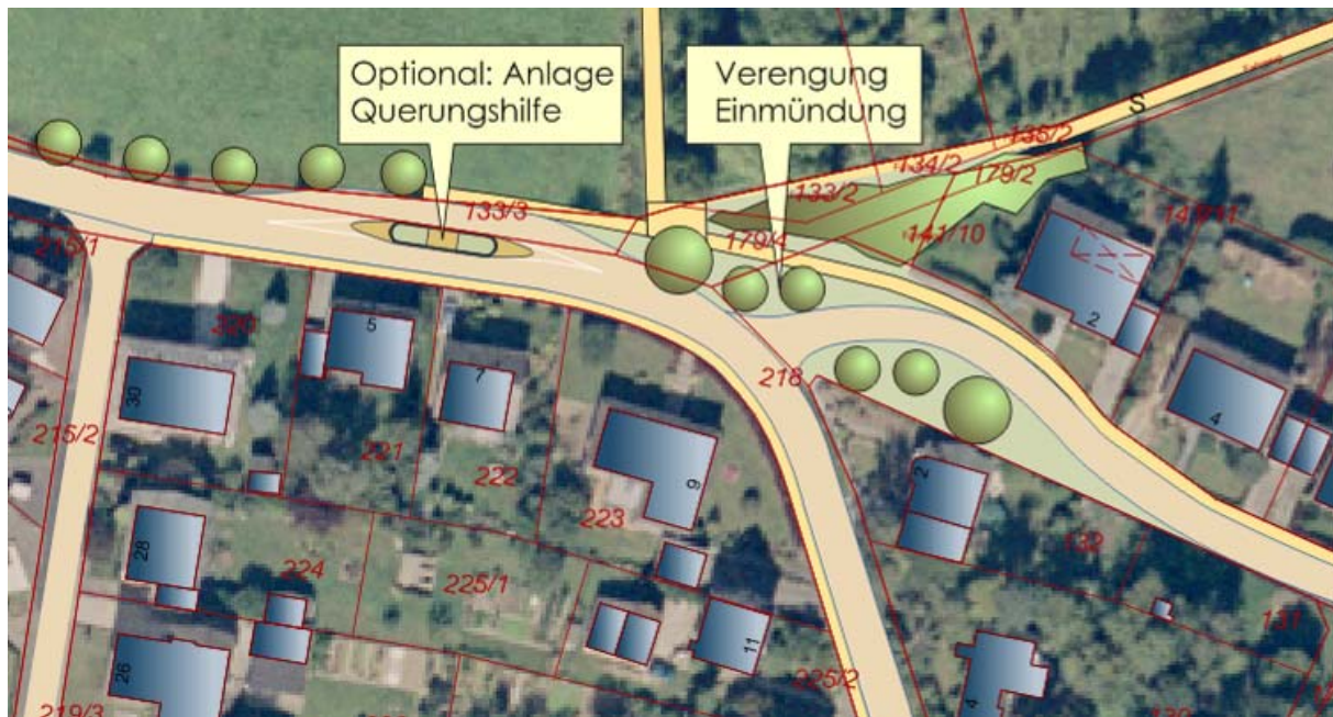
Abb.: Ursprüngliche Ideenskizze zur Einengung des Einmündungsbereichs und Anlage einer Querungshilfe, ohne Maßstab
